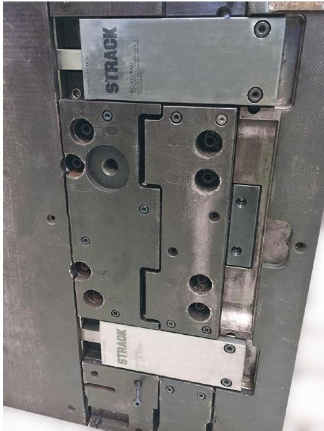
Z4 Klinkenzüge für 2 Trennebenen bündig eingelassen ins Werkzeug
