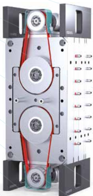
Vue arrière 32 x partie mobile complète de dévisage Back view 32x unscrewing half
