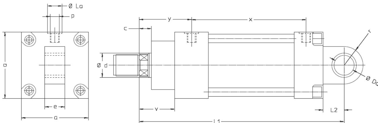
La fixation par articulation arrière est munie d'une douille.
