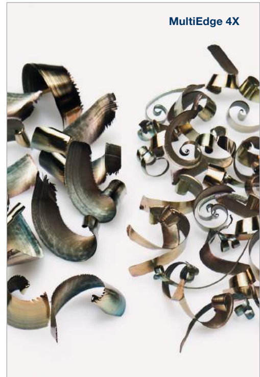
MultiEdge 4X: Kleine Späne durch Spanteilung MultiEdge 4X: Small chips because of chip division
