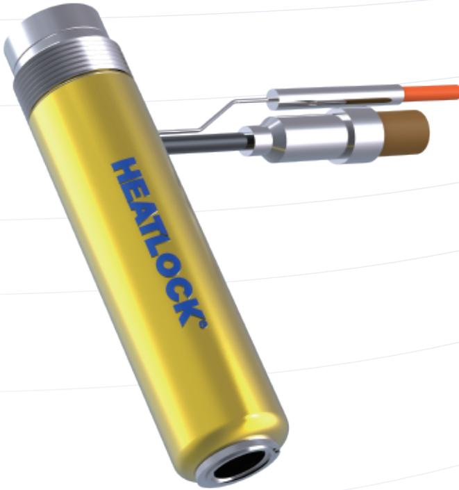
ALL-IN-ONE et la technologie AO-LOCK. Avec le nouveau système unique AO-LOCK, les buses sont vissées au distributeur pour obtenir une étanchéité à 100 %. Cela permet également de positionner avec précision les sorties de câble de manière à ce qu'elles correspondent aux découpes du moule. De cette façon, le système complet de canaux chauds peut être installé dans le moule en une seule étape.
