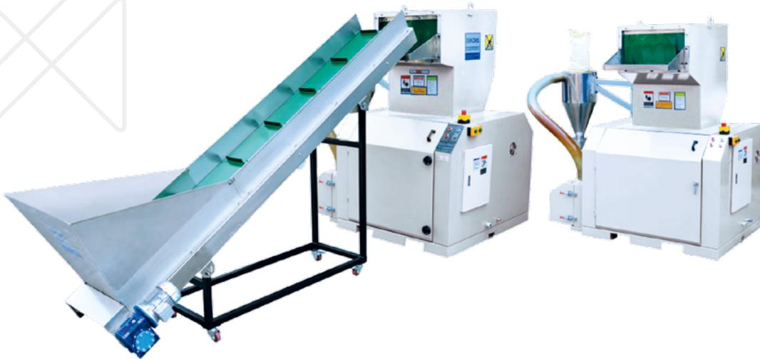
Les grands granulateurs de la série FC sont construits avec des matériaux de haute densité qui couvrent tout l'équipement tout en permettant un accès rapide à la chambre de broyage pour remplacer les lames.
