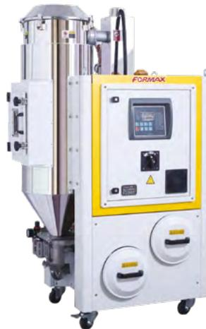
Les déshumidificateurs compacts de la série FDD sont équipés d'un déshumidificateur en nid d'abeille et d'un sécheur à trémie. En fait, chaque modèle combine les fonctions de déshumidification et de séchage dans une seule unité (2 en 1). Ils fonctionnent avec un processus de cycle fermé et continu avec un point de rosée (DEW-POINT) de  $-40^{\circ}\text{C}$  (option  $-50^{\circ}\text{C}$ ).
