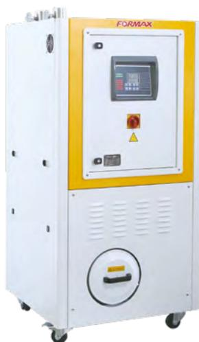
Les déshumidificateurs de la série HCD sont conçus selon le principe « HONEYCOMB ROTOR » et fonctionnent avec un processus en cycle fermé et continu avec un point de rosée (DEW-POINT) de -40°C. Le rotor est divisé en une zone de traitement et une zone de régénération, séparées l'une de l'autre par des joints résistants à la chaleur.
