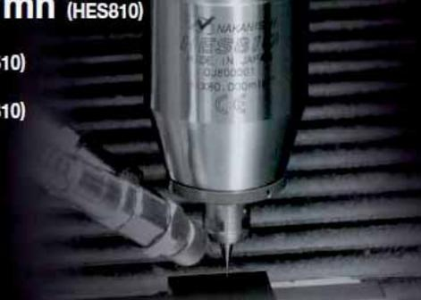
Fraisage et perçage avec outil de diamètre inférieur à 3 mm. Obtention d'excellents états de surface. Egalement pour le polissage, l'ébavurage et le brossage.
