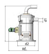
Les alimentations triphasées des séries S et SV sont entièrement construites en acier inoxydable et sont équipées d'un filtre d'aspiration en tissu.
